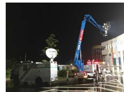
被災地支援の準備を進める 照明車と衛星通信車 (鹿児島県南さつま市役所)
